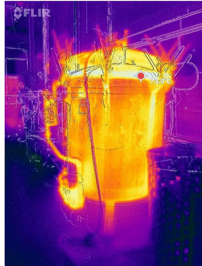
Autoclave vapeur ancien, mal calorifugé
